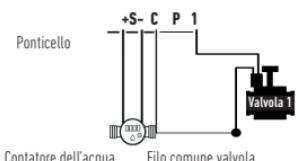
Collegare l'ingresso + S - a un contatore dell'acqua dotato di un sensore di flusso come mostrato sopra. Utilizzare sensori di flusso a contatto secco o equivalenti. Per i sensori di flusso polarizzati, durante il cablaggio, osservare la polarizzazione:
