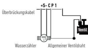
Schließen Sie Ihren + S - Eingang an einen Wasserzähler an, der mit einem Durchflusssensor ausgestattet ist, wie oben gezeigt. Verwenden Sie Trockenkontakt-Durchflusssensoren oder gleichwertige. Bei polarisierten Durchflusssensoren ist bei der Verdrahtung die Polarisierung zu beachten:
