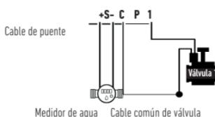
Conecte su entrada + S - a un medidor de agua equipado con un sensor de flujo. Utilice sensores de flujo de contacto seco o equivalentes. Para sensores de flujo polarizados, observe la polarización al realizar el cableado:
