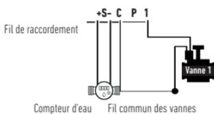
Branchez votre entrée + S - à un compteur d'eau équipé d'un capteur de débit. Utilisez des capteurs de débit à contact sec ou équivalent. Pour les capteurs de débit polarisés, respectez la polarisation lors du câblage :
